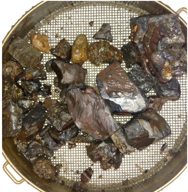
Figur 1: Prov på slaggavfall från Kaveltorps före detta koppar- och blyverk. Materialet på bilden utgör delprov av det undersökta samlingsprovet på slaggavfall.
